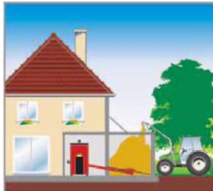
Cuarto de la caldera en planta baja con silo de combustible cerrado en otra habitación
