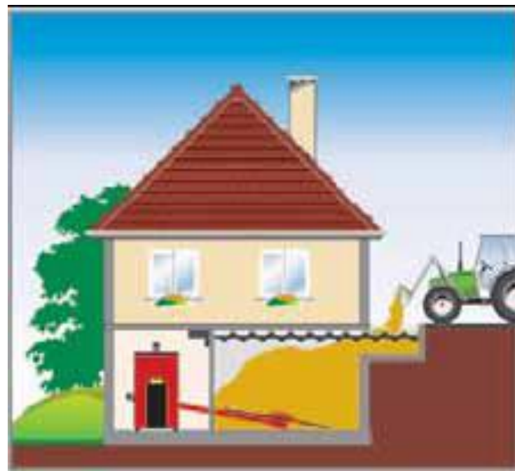
Cuarto de la caldera bajo el suelo con silo de combustible alimentado mediante tornillo sin fin
