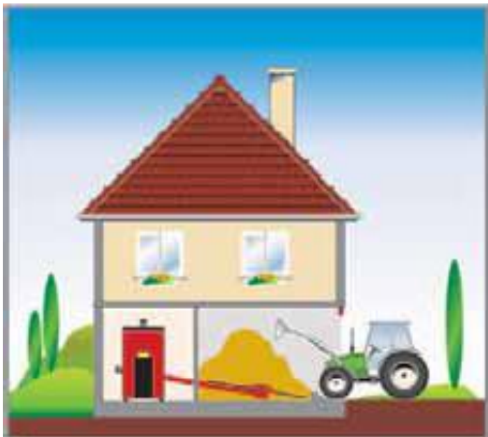
Cuarto de la caldera en planta baja y almacén de combustible al lado, abierto al exterior
