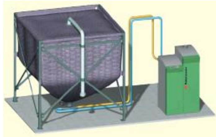
Sistema de almacenamiento de pellets en silo de bolsa combinado con sistema de aspiración
