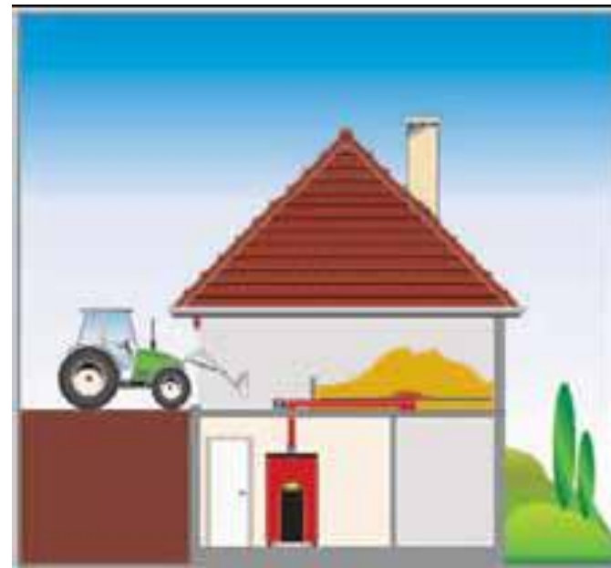
Cuarto de la caldera bajo el suelo con silo de combustible encima de la caldera
