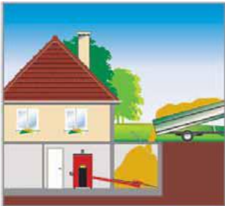
Cuarto de la caldera bajo el suelo con silo de combustible enterrado y a nivel de la caldera
