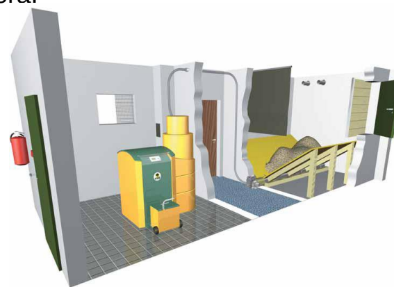
Sistema de alimentación neumático desde almacén
