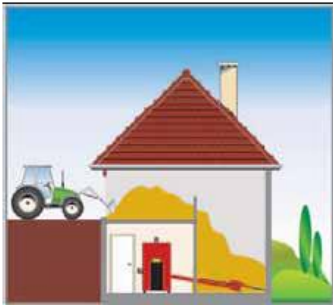
Cuarto de caldera bajo el suelo y silo de combustible al lado, con reserva sobre el cuarto de caldera
