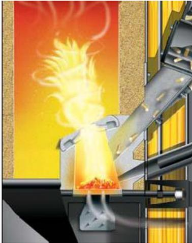
**2. De ladrillos refractarios :** más caros que el acero, poseen una mayor resistencia al almacenamiento de calor. Fabricantes como Binder o Fröling utilizan este material en la cámara de combustión
