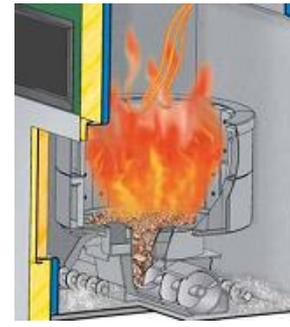
**Limpieza de las cenizas mediante plato vibratorio**
