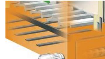
**Limpieza de cenizas mediante suelo móvil**
