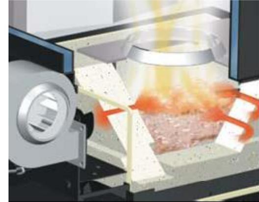
**3. De carburo de silicio:** Su elevado precio se justifica por el hecho de que no reacciona con la ceniza y es resistente a que se formen depósitos y escoria, por lo que resulta ser un material muy adecuado para la combustión. Este tipo de material se encuentra por ejemplo en la cadera Guntamatic Biostar cuya cámara de combustión está recubierta con una camisa de carburo de silicio resistente al fuego
