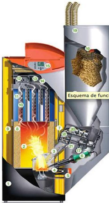
Esquema de funcionamiento de caldera de pellets
